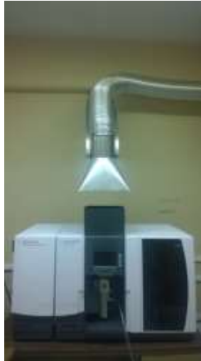
Figura 2. Espectrofotómetro de absorción atómica Agilent Technologies 200 series AA.
