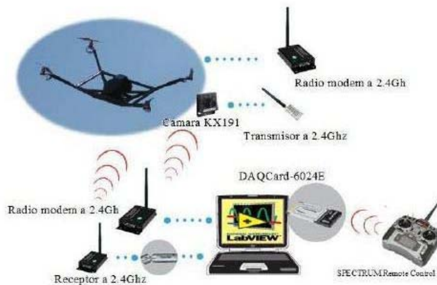
Figura 5. Esquema de comunicación entre el software y el quadrotor
