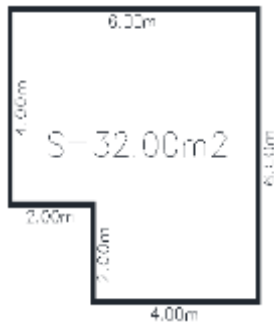
Figura 2. Área de captación.
