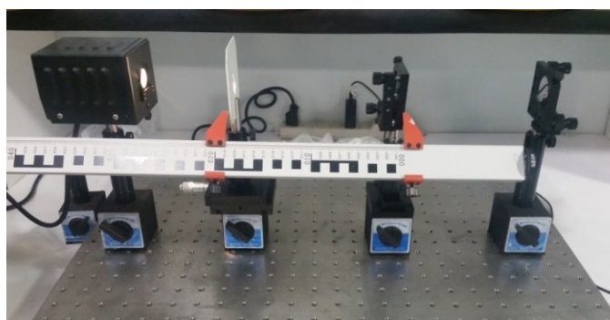
Figura 1. Arreglo experimental para medir el punto focal de una lente positiva.
