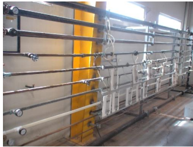
Figura 1. Red de flujo de tuberías
