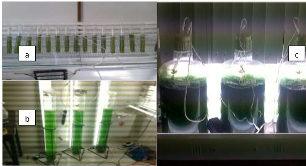
Figura 1. Fotobiorreactores para el cultivo de microalgas; a) 60 mL, b) 6 L y c) 19 L.
