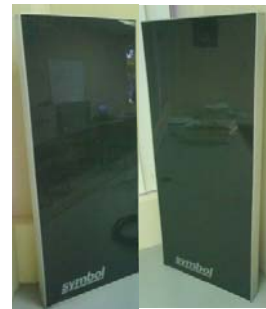
Figura 6. Antenas AN400 con 6dBi lineales de ganancia.
