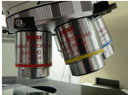
Figura 11. Lentes objetivos de un microscopio.
