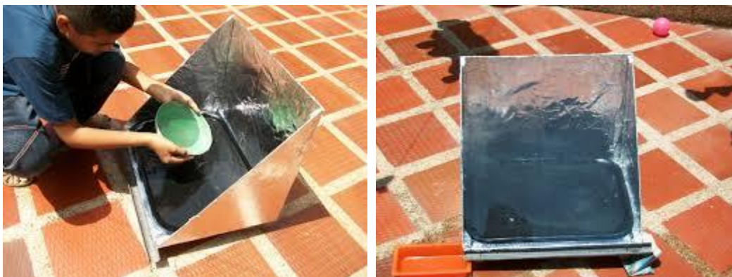
Figura 8. Destilación solar tipo caseta en México (Buros, 2000).
