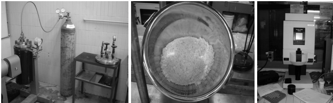
Figura 2 Reactor para el blanqueo y equipo para medir blancura
