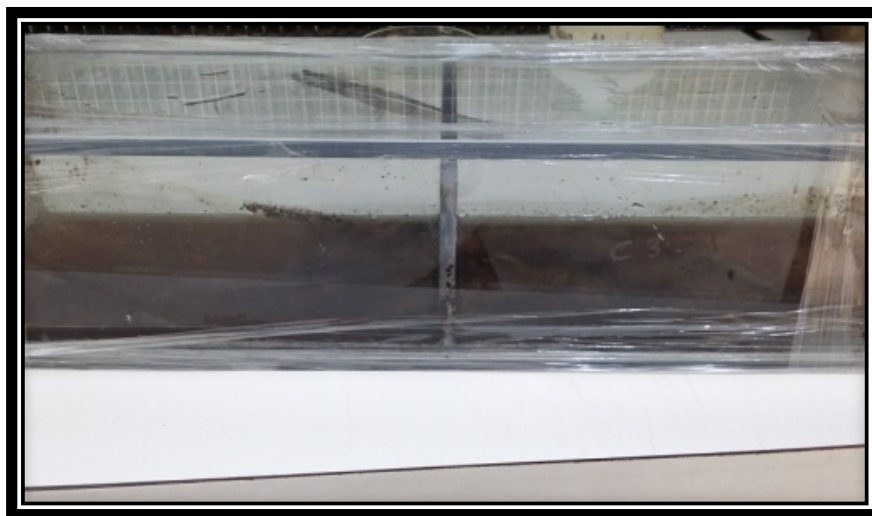
Figura 4. Contaminación fúngica y bacteriana de brotes de sábila en el contenedor del biorreactor de inmersión temporal.
