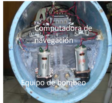
Fig. 6 Computadora de navegación y equipo de bombeo instalado dentro del casco del Sub-Chaac.
