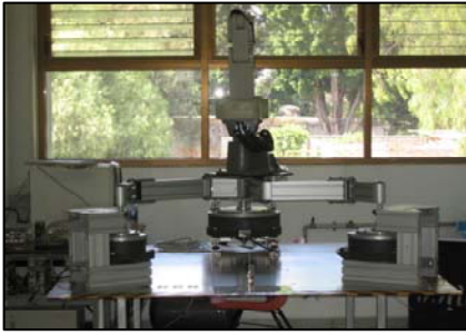
Fig. 1 Manipulador paralelo desarrollado en el ITC.
