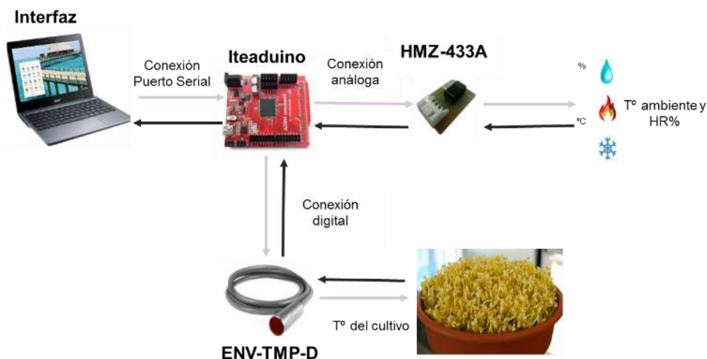
Figura 2. Diagrama de los componentes empleados para el SAD.
