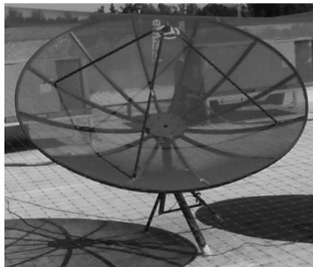
Figura 4. Plato parabólico concentrador.
