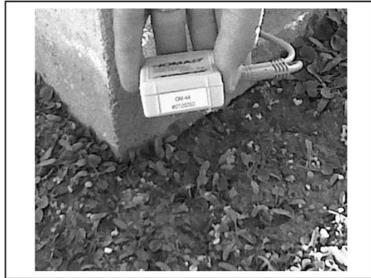
Figura 5. Colocación de sensor térmico en Azotea Verde.
