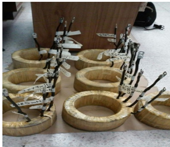
Figura 9. Bobinas de acoplamiento.
